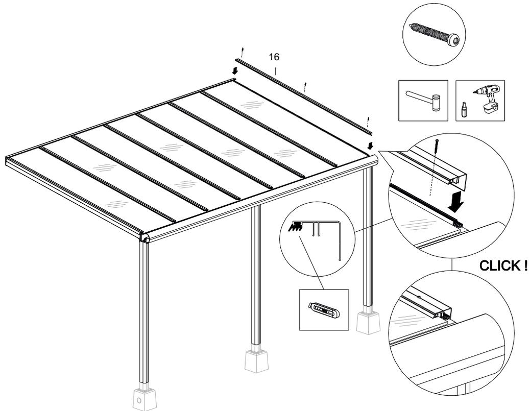
10. Jetzt als zusätzliche Sicherung an der Rinne auf jedem Zwischenträger einen Plattenstopper schrauben.
