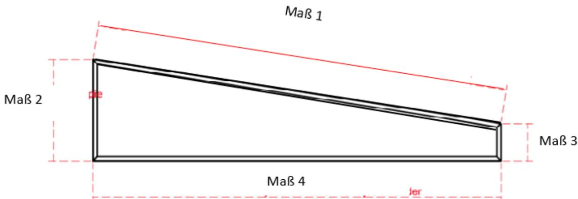
Bestimmen Sie nun den Neigungswinkel der Überdachung und nehme die Maße von 1 und die oberen Ecken von Maß 2 (Maß X1 kleiner als 90°) und 3 (Maß X2 größer als 90°). Die Enden der Länge 4 und die unteren Ecken der Maß 2 und 3 müssen einen Winkel von 90° (2x 45°) bilden (Gehrung).
